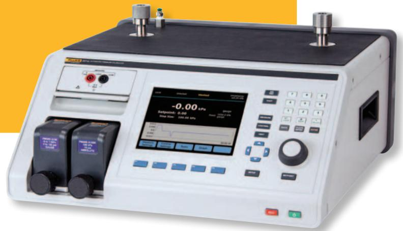
Der Industrie-Druckkalibrator 2271A von Fluke Calibration stellt eine komplette automatisierte Lösung zur Kalibrierung einer großen Vielfalt von Manometern und Drucksensoren dar. Dank seines modularen Aufbaus kann er an unterschiedliche Bedürfnisse und Budgets angepasst und bei Bedarf erweitert werden, wenn sich Ihr Aufgabenbereich vergrößert.
