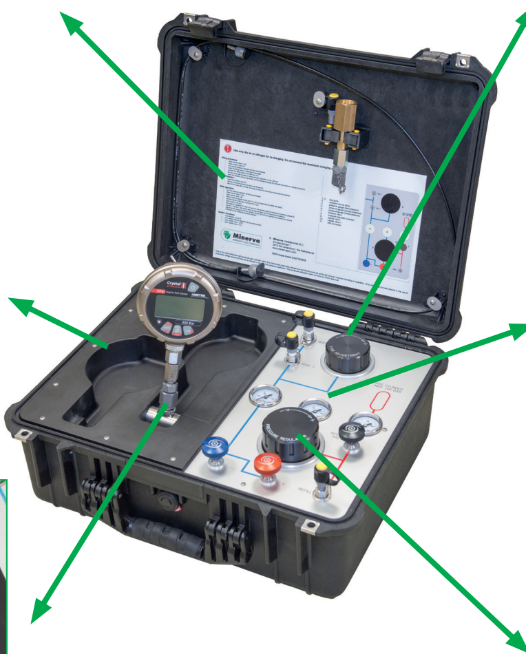
Der präzise variable Volumeneinsteller Minerva MNR 90 ermöglicht eine sehr feine Druckeinstellung bis hinunter auf 100 Pa.
